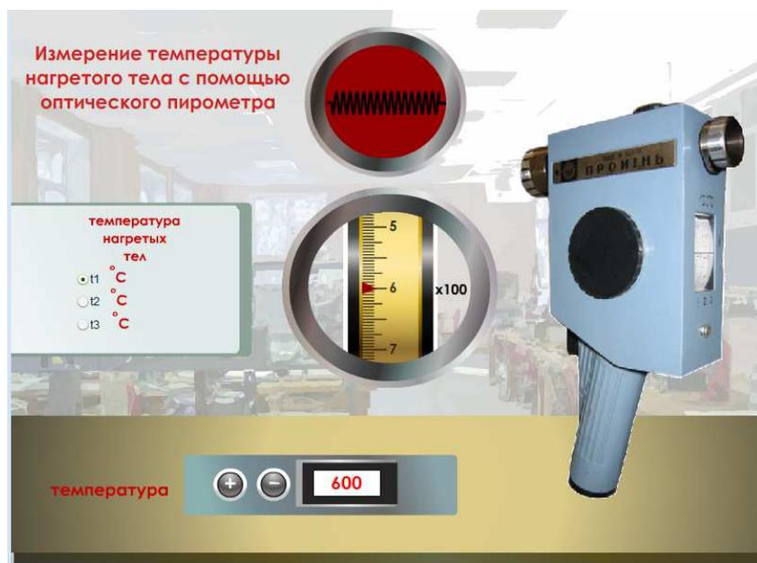
Рис. 5. Интерактивная виртуальная установка для определения температуры нагретых тел
