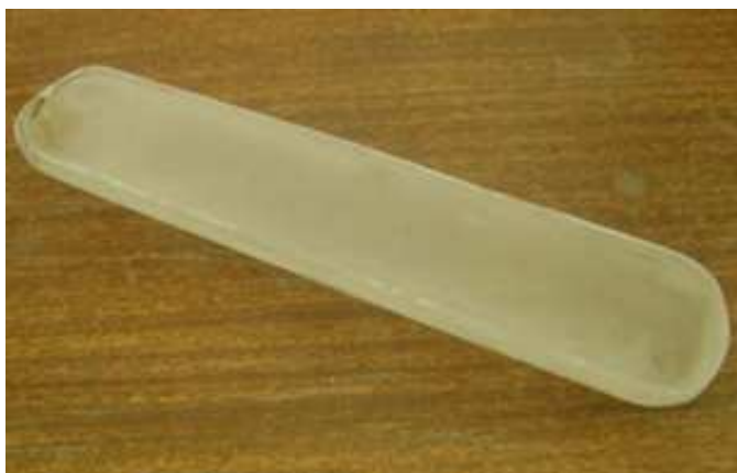
Рисунок 2 – Кварцевая лодочка с покрытием диоксида кремния состава ТЭОС:С 3 Н 6 О:Н 2 О:ННО 3
