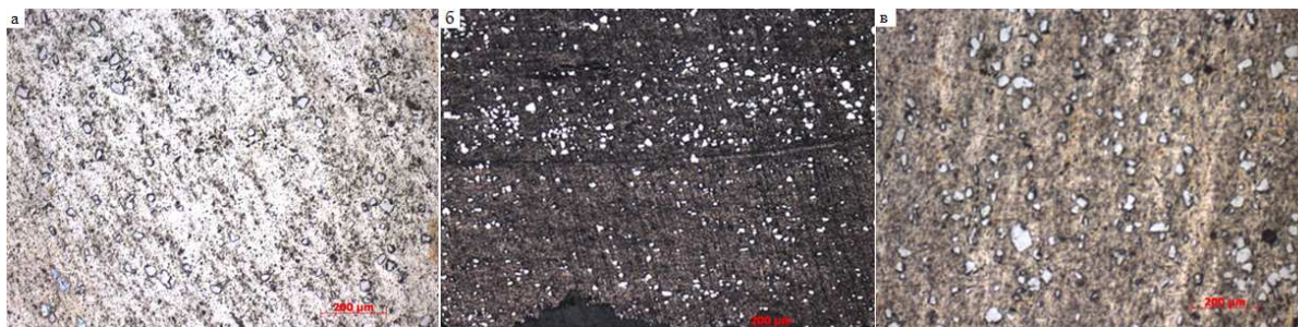
Рисунок 6 – Микроструктуры образцов прокатанных при температуре 580 °С диаметром 9 мм, а) \dot{\epsilon}=0,74 \text{ сек}^{-1} б) \dot{\epsilon}=1,49 \text{ сек}^{-1} в) \dot{\epsilon}=5,49 \text{ сек}^{-1}
