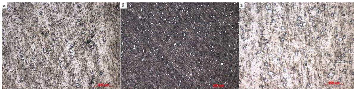
Рисунок 5 – Микроструктуры образцов прокатанных при температуре 580 °С диаметром 7 мм, а) \dot{\epsilon}=0,74 \text{ сек}^{-1} б) \dot{\epsilon}=1,49 \text{ сек}^{-1} в) \dot{\epsilon}=5,49 \text{ сек}^{-1}
