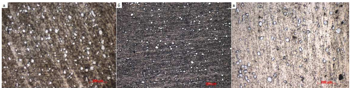
Рисунок 4 – Микроструктуры образцов прокатанных при температуре 580 °С диаметром 5 мм, а) \dot{\epsilon}=0,74 \text{ сек}^{-1} б) \dot{\epsilon}=1,49 \text{ сек}^{-1} в) \dot{\epsilon}=5,49 \text{ сек}^{-1}
