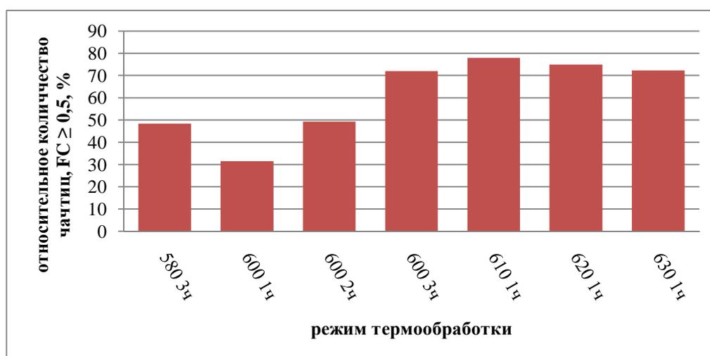
Рисунок - Относительное количество частиц железосодержащих фаз,  $FC \geq 0,5$  при различных режимах отжига.
