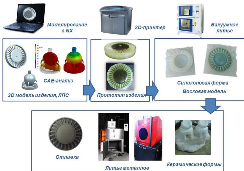
Рисунок 1 – Технология изготовления рабочего колеса турбины мини-ГТД
