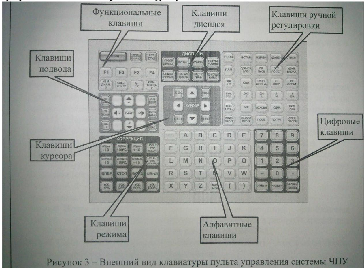
Рисунок 3 – Внешний вид клавиатуры пульта управления системы ЧПУ
