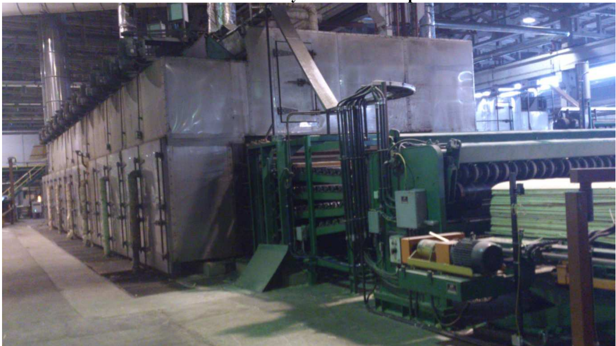
Рисунок 1.1 – Общий вид сушильной камеры шпона
