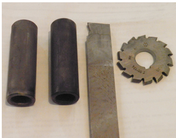
Рисунок 3. Полученные хром-наноалмазные покрытия, нанесенные на медный подслои.
