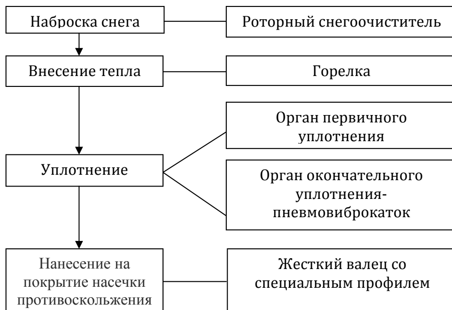
Рисунок 4 - Схема модернизированной технологии по созданию снеголедовых автодорог
