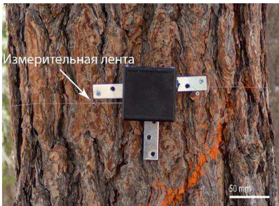
Рисунок 1 – Датчик размещенный на стволе при испытаниях
