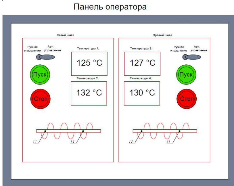
Рис. 2 Интерфейс управляющего контроллера S7-1200.
