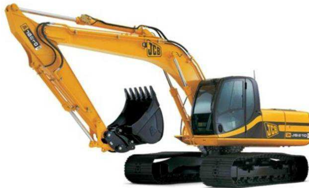
Рисунок 3 – Экскаватор на гусеничном ходу
