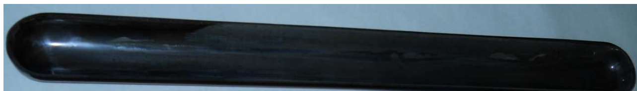
Рисунок 1 – Кварцевый контейнер с покрытием на основе ПГМГ
