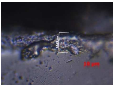
Рисунок 2 – Кварцевый контейнер с покрытием 15% полигексаметиленгуанидин гидрохлорида толщиной 13,76 мкм
