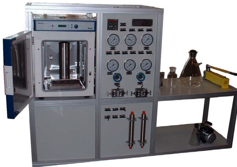
Рис.2. Внешний вид установки для определения относительной фазовой проницаемости ПИК-ОФП/ЭП-3
