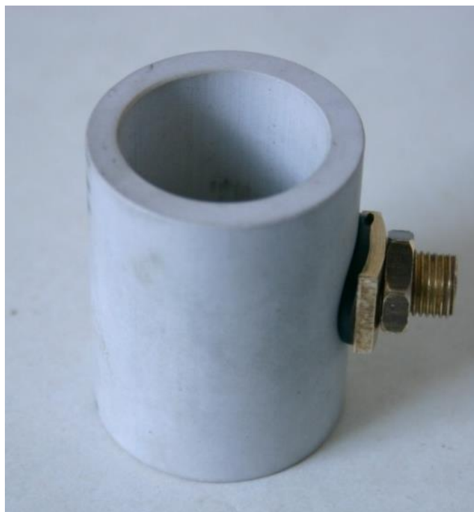
Рис. 6. – Внешний вид камеры, заполняемой исследуемым образцом
