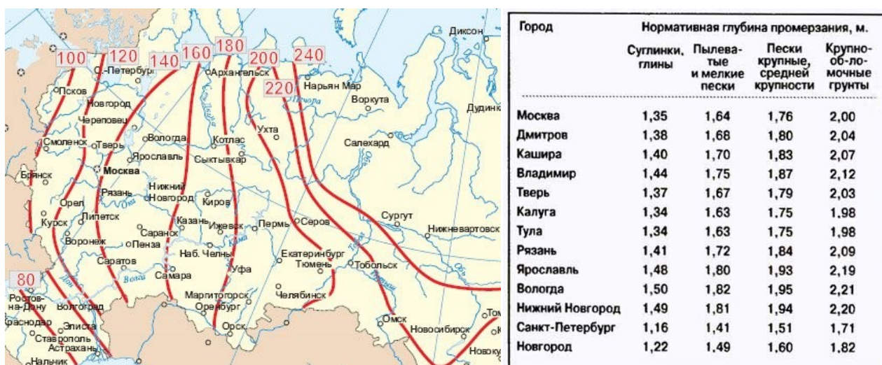
Рис. 6. Схематическая карта глубины промерзания глинистых и суглинистых грунтов на территории Европейской части России и Западной Сибири (см) и сведения о глубине промерзания для разных видов грунтов
