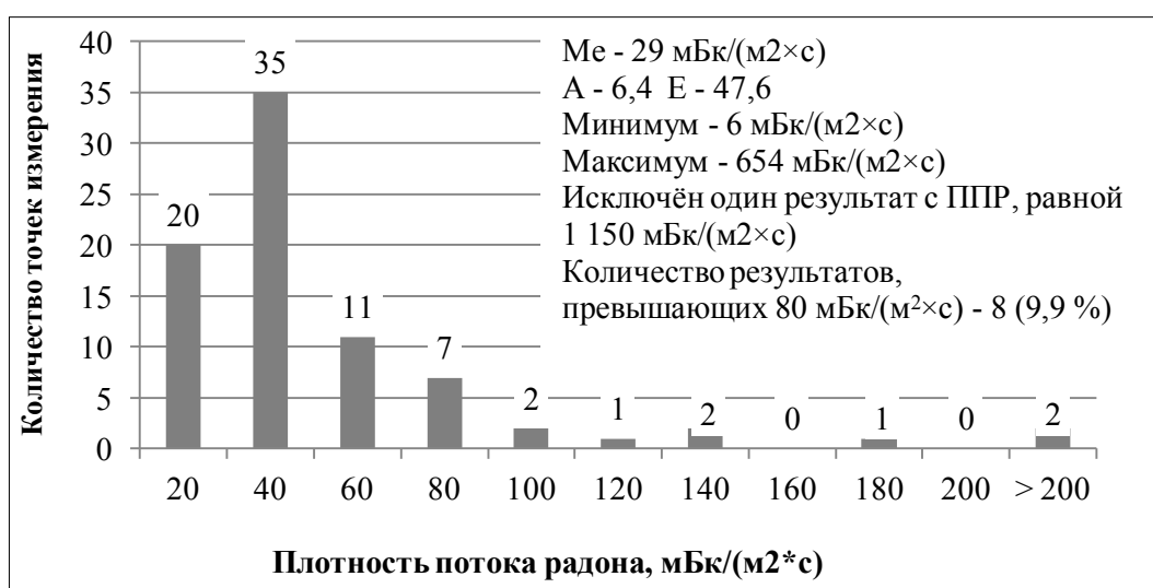
Рис. 5. Частотное распределение результатов измерения ППР, полученных на участках Северной, Центральной и Южной аномалий
