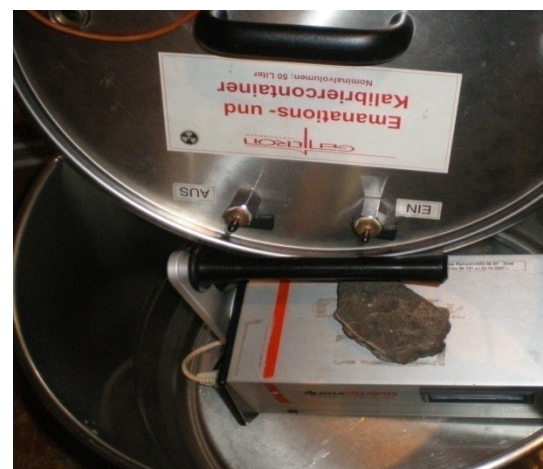
Рис. 5. Лабораторная установка для эманационных испытаний
