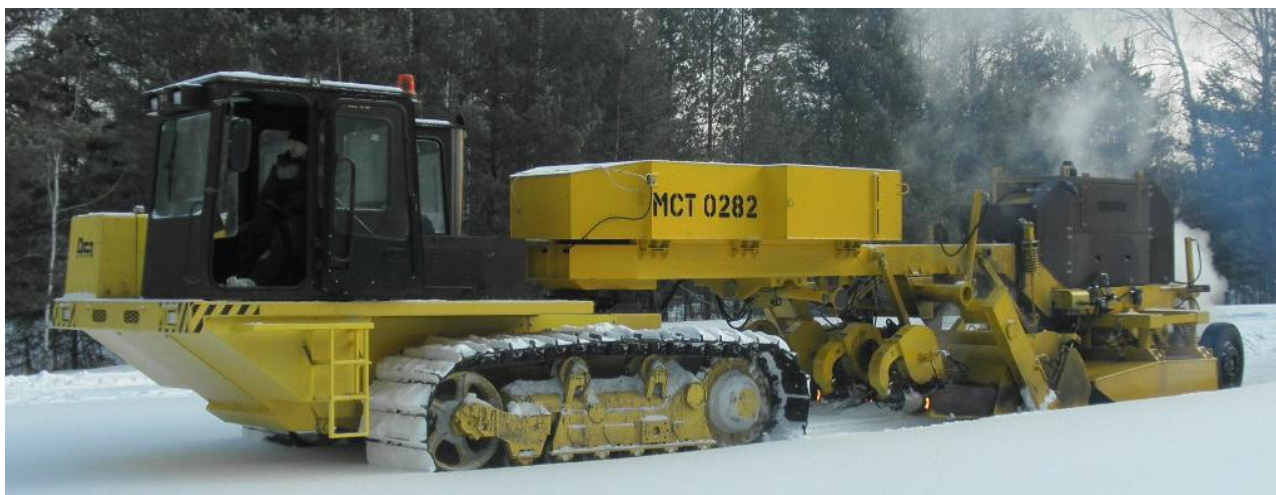
Рис. 2. Снегоуплотняющие машины: а – термовибрационная машина СТМ-2; б – термовибрационная снегоуплотняющая машина СТМ-2А; в – снегоуплотняющая машина для строительства зимних дорог МСТ-0282
