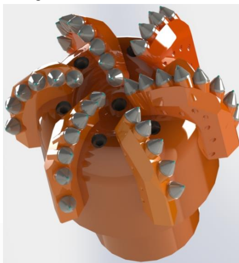
Рис. 9. Лопастной буровой инструмент с поворотными резцами
