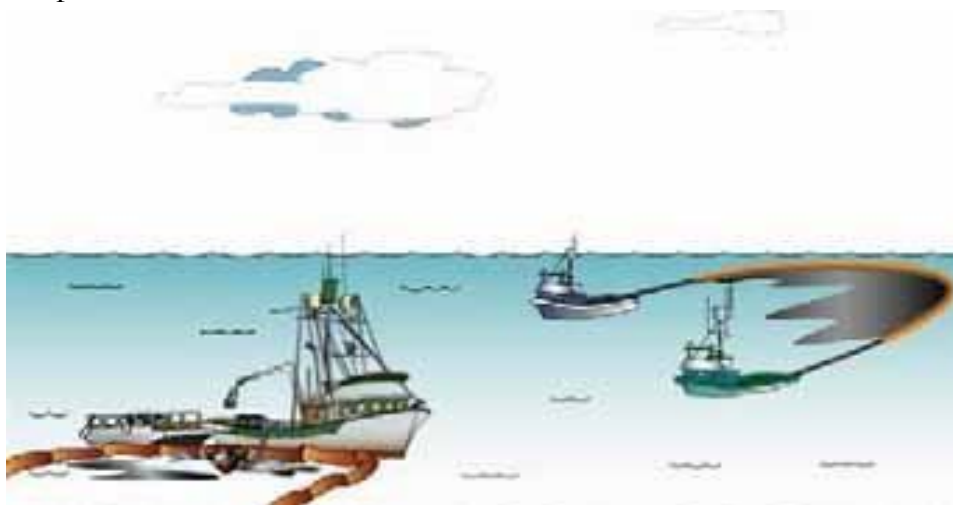
Рисунок. Типовая надводная система механической ликвидации нефтяных разливов [1]
