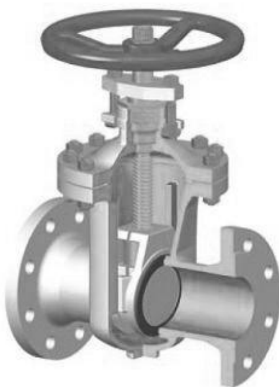
Рисунок. Пример шиберной задвижки в разрезе
