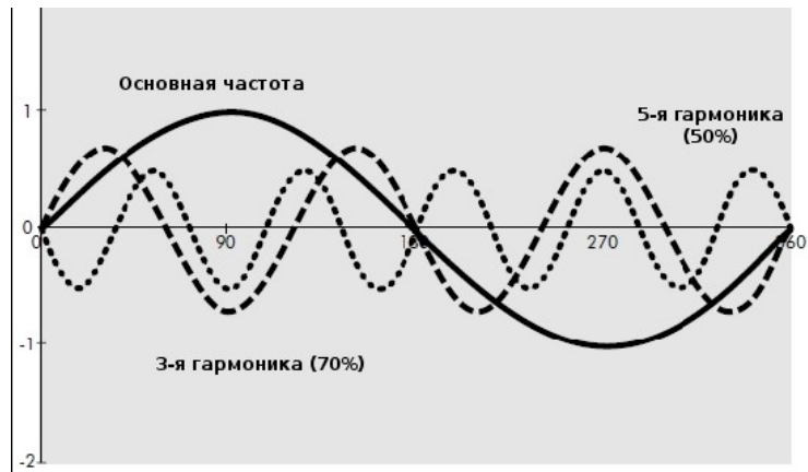
Рис. 1. Основная частота с гармониками 3-го и 5-го порядков
