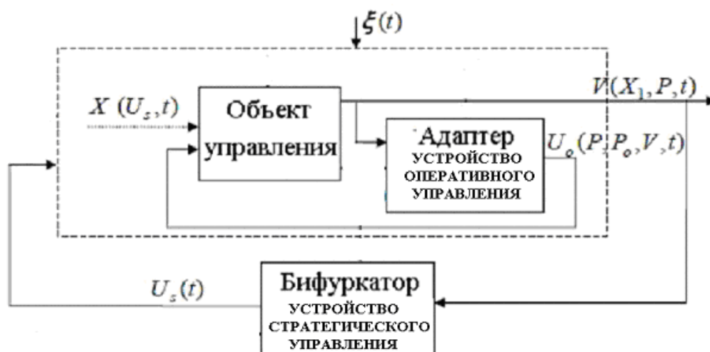
Рисунок 1 – Двухконтурная система управления сложным объектом
